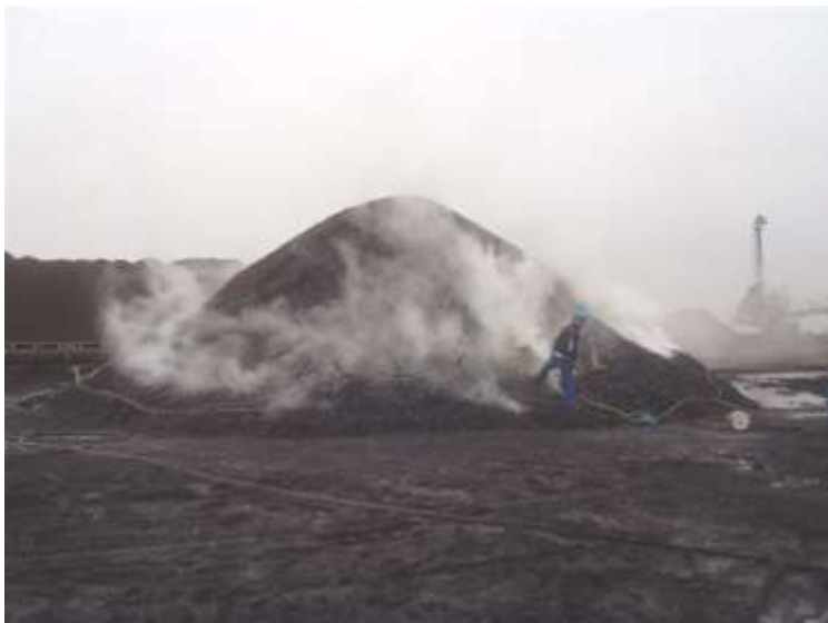
Obrázek 3 – Monitoring deponie uhlí ve stádiu rozvinutého záparu uhelné hmoty
