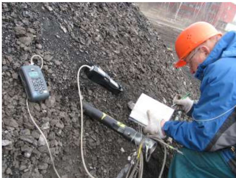
Obrázek 2 – Měření majoritních plynů analyzátorů Dräger X-AM 5600 a Geotech G110
