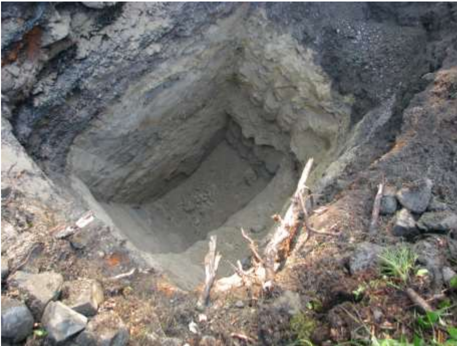
Obr.1: Sonda k ověření dostupnosti gravitačních písků
