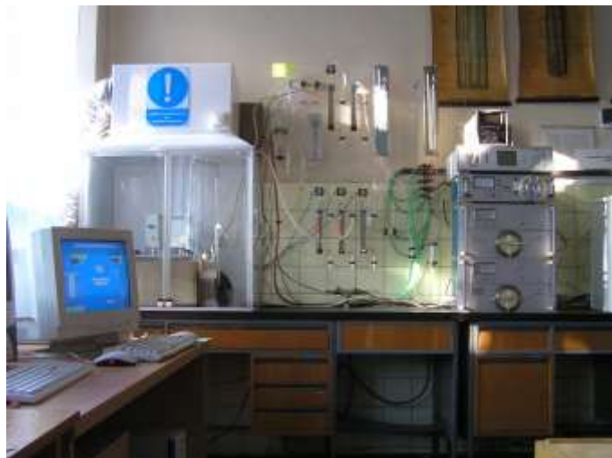
Obr. 1: Měřicí aparatura modifikované adiabatické metody spolu s plynovou linkou
