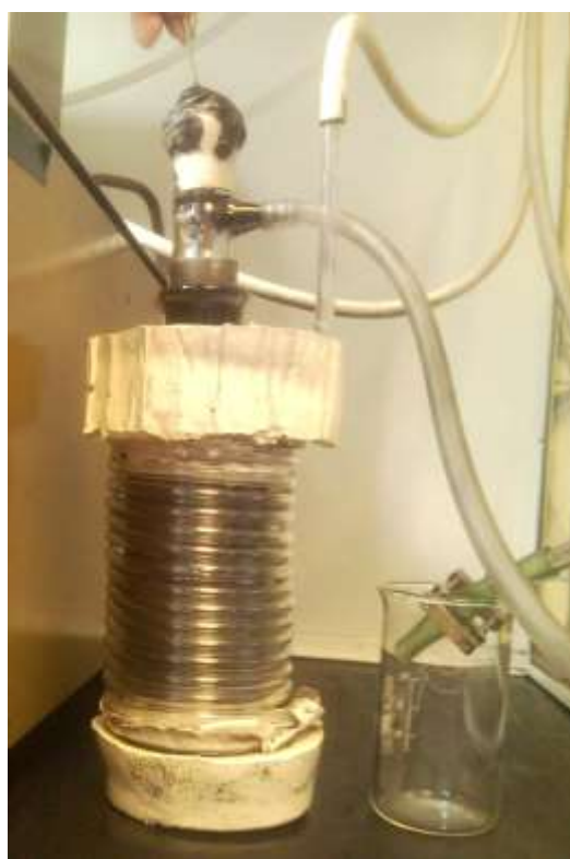
Obr. 2: Reakční nádoba adiabatického termostatu
