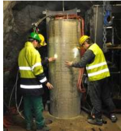
Obr. 5 - Rozměry modelu Mock-up Josef v mm s naznačeným umístěním topného tělesa a s označením umístění vodorovných monitorovacích profilů (I až V) [5.] Vpravo foto ze spuštění modelu do úložné studny (foto archiv autora článku).
