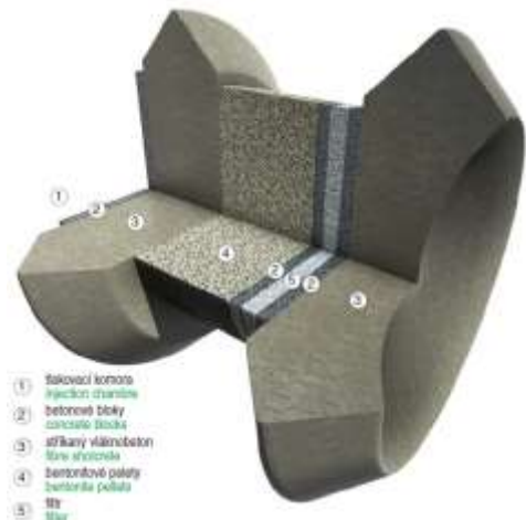
Obr. 7 – Demonstrační experiment zátky EPSP (vlevo konstrukční řešení – podélný řez zátkou,
