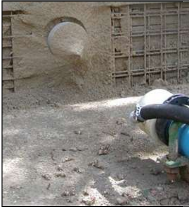
Obr. 4 – Foto vzorku po nástřiku a grafické znázornění výsledků objemové hmotnosti sušiny (dry density v \text{Mg/m}^3 ) a vlhkosti (water content v %) po nástřiku vzorků materiálu označeného jako Ultra bentonit UB [3.]
