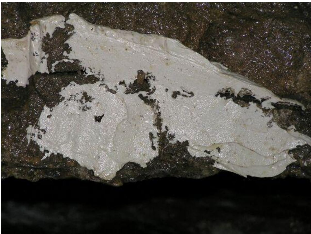
Obr. 1 Příklad sádrového terčíku (T9) na sledované subhorizontální puklině
