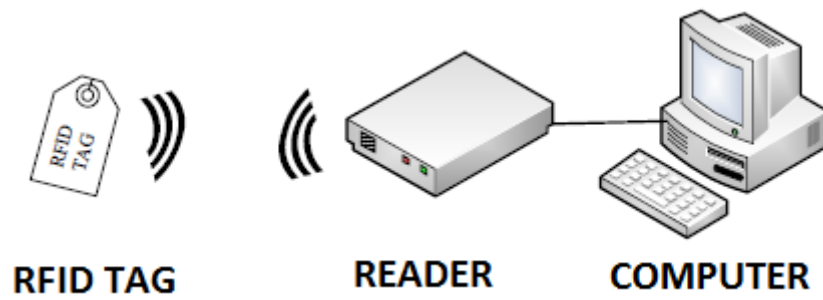
Obr. 1 : Schéma zapojení tagu a počítače
