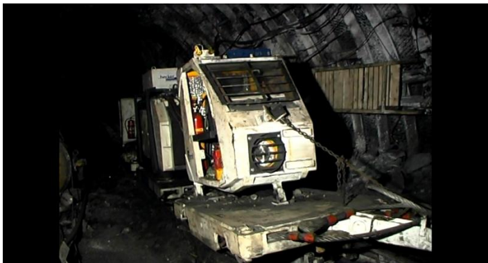
Obr. č. 2 Doprava pomocí ozubnicové dráhy a dieselového tahače [3].
