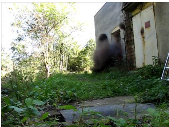
Obr. 5: Odfuk uhlého prachu po rozprášení a protržení folie v oknech
