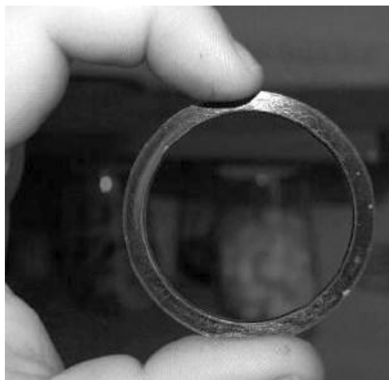
Obr. 2: LF RFID tag, který se implementuje do bezpečnostních lamp
