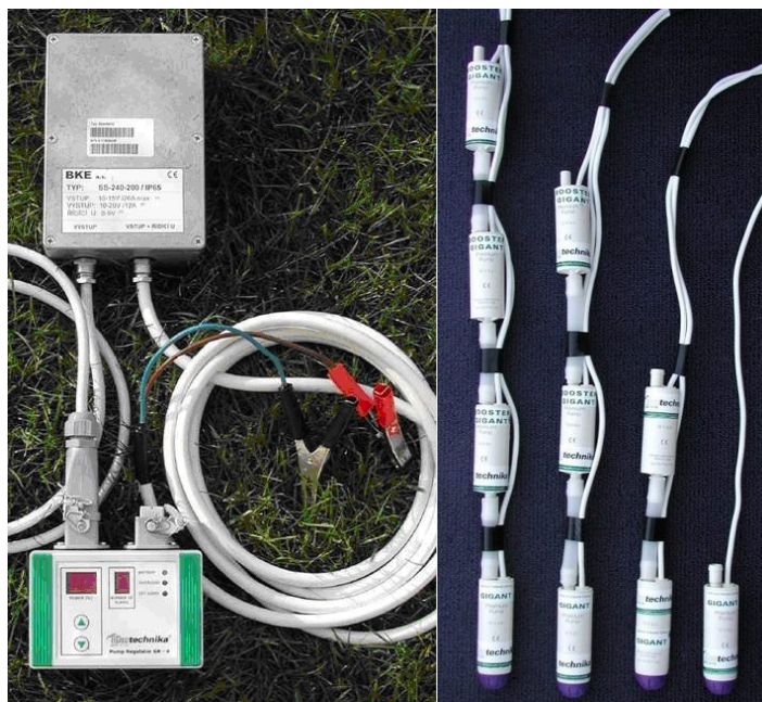
Obr. 1: Čerpadla Gigant a regulátor průtoku GR4
