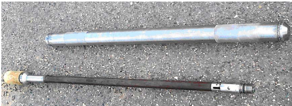
Obr. 5: Vzorkovač SMK se vzorkovnicí o objemu 2 l
