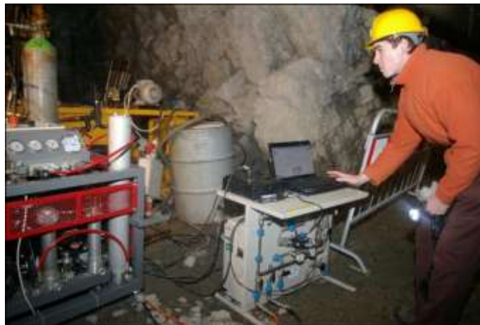
Obr 4. Sestava pro měření plynopropustnosti hornin.
