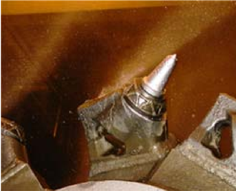
Obr. 6 Detailní pohled, funkce postřiku na řezný orgán razícího kombajnu JOY typu Wethead
