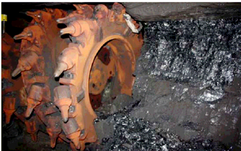
Obr. 5 Řezný orgán dobývacího kombajnu na dole UBB
