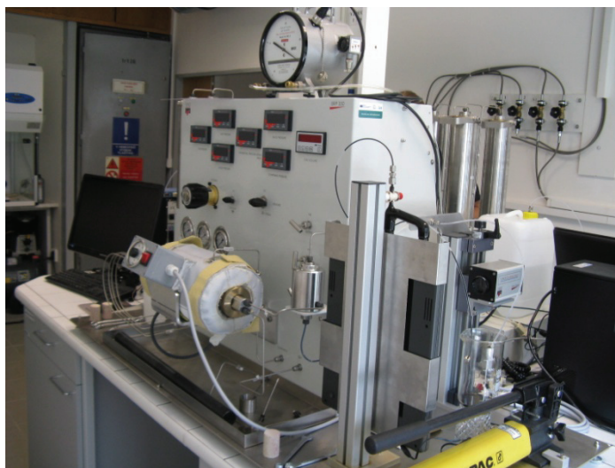
Obr. č. 2: filtrační aparatura BRP 350 (Laboratoř stimulace vrtů a ložisek uhlovodíků)
