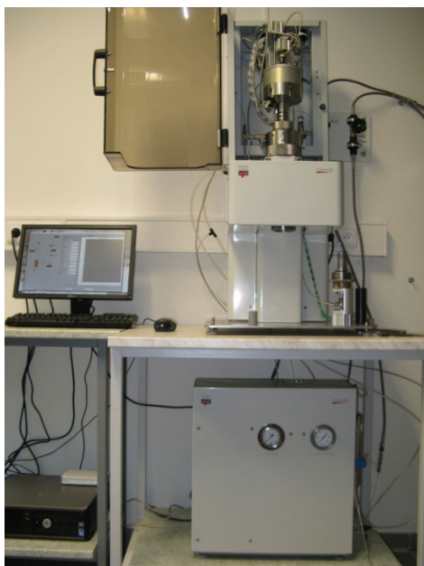
Obr. č. 1: Automatický permeametr a porozimetr (Laboratoř stimulace vrtů a ložisek uhlovodíků)
