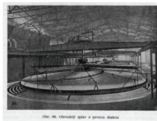
Obr. 86. Okrouhlý splav s pevnou deskou
