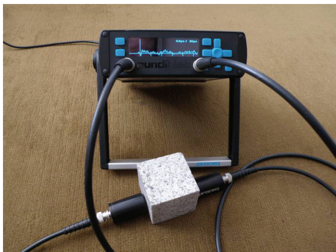
Obr. 1 Aparatura Pudít Lab + pro měření rychlosti šíření ultrazvukových vln (foto: Kaláb)
