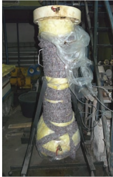
Obr. č 2 – Aparatura MAF 1 s tepelnou izolací. Stav před temperováním (foto autorka).
