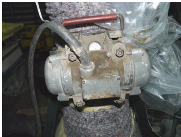
Obr. č. 6 – Vibrační zařízení umístěné na plášti aparatury MAF I (foto autorka).
