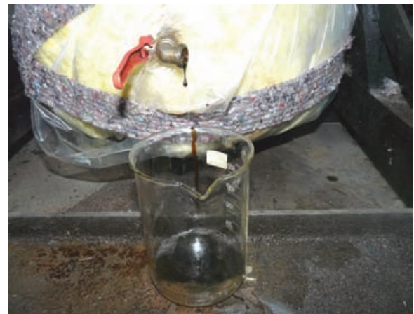
Obr. č. 7 – Odtokový ventil. Gravitační filtrace – odkapávání ložiskové vody a ropu (foto autorka).
