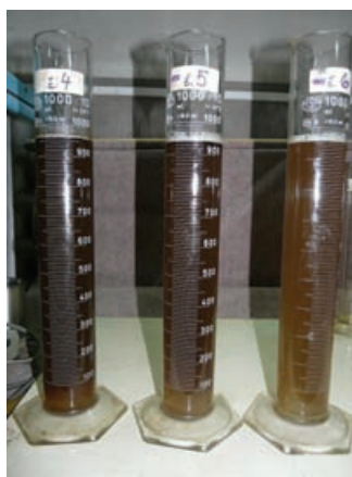
Obr. č. 9 – Směs karbonizované vody ihned po odfiltrování stanoveného objemu směsi při tlaku 1 MPa (foto autorka).
