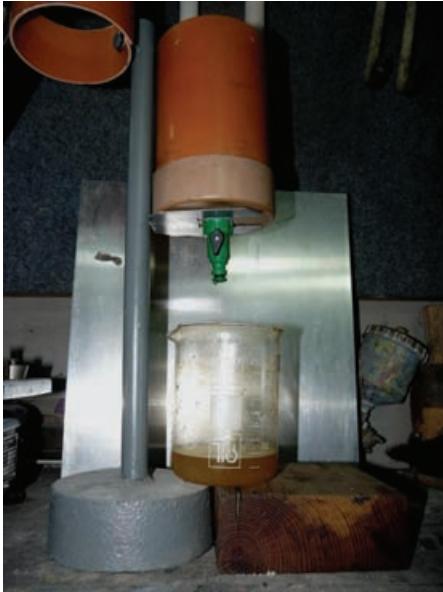
Obr. č. 4 – Odkapané množství ložiskové vody (foto autorka).
