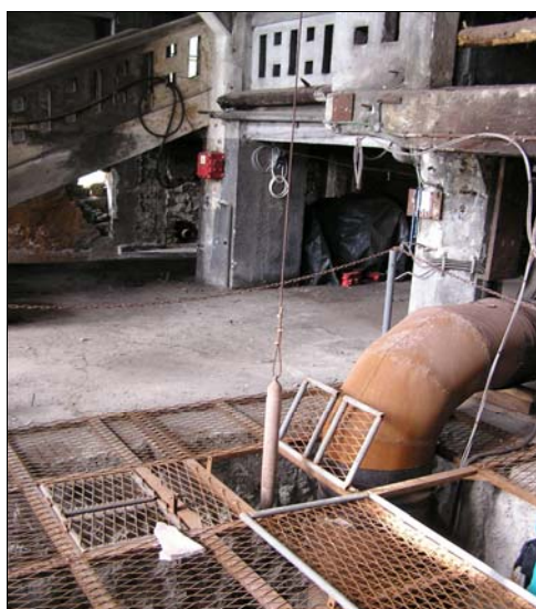
Obr. 3.8 Sonda pro měření hladiny zásypu v jámě
