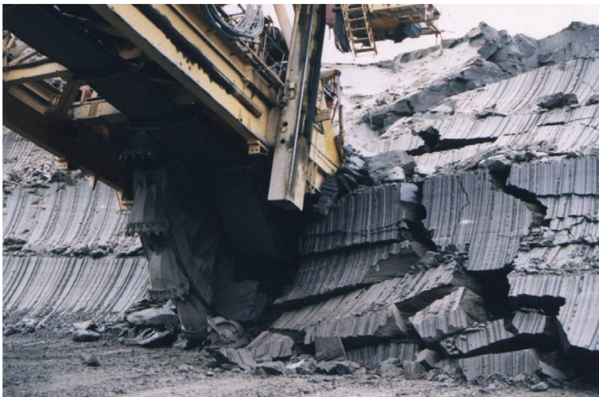
Obr. 4 Skluz zeminy na špičku kola (1997)
