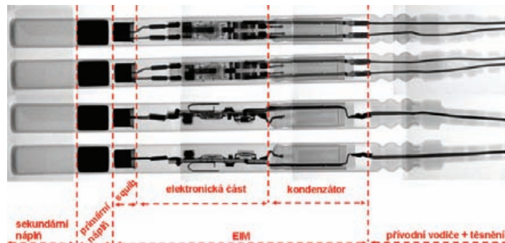
Obrázek 5: RTG rozbušky E*Star s vyznačením základních částí
