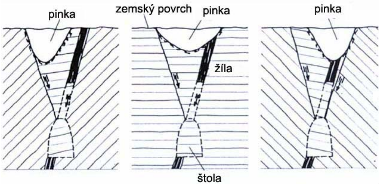
Obr. 1 Tvar pinky v závislosti na uložení vrstev
