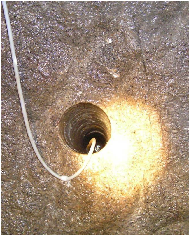
Příloha 2 Pohled do vrtu s nalepenou tenzometrickou sondou v komoře K1
