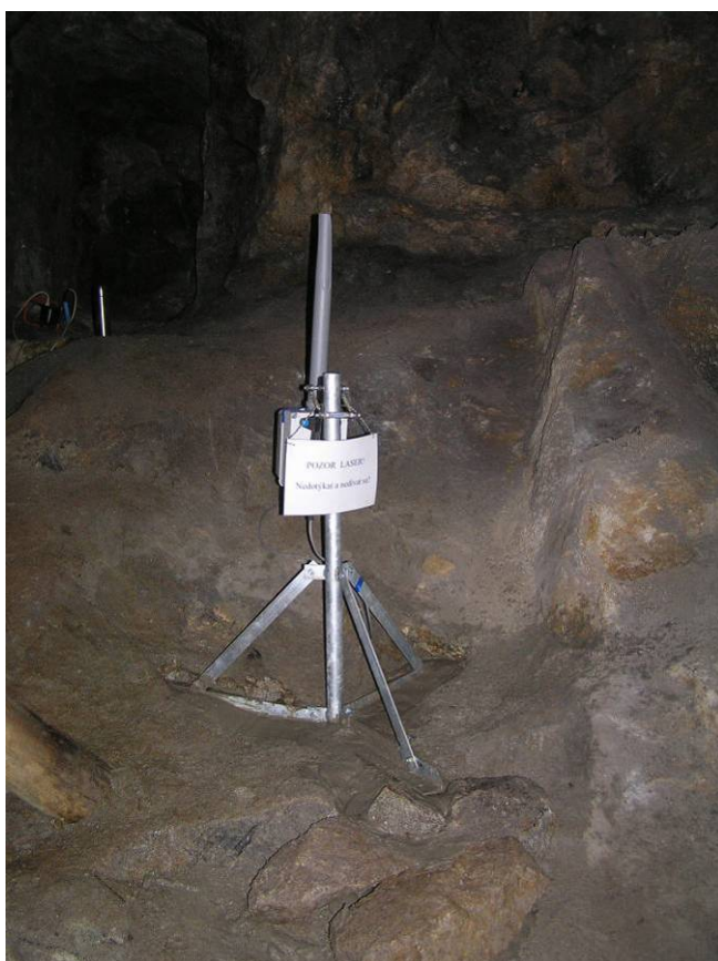
Příloha 4 Stojan s laserovým dálkoměrem ve vodotěsném pouzdru v K2
