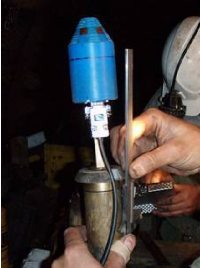
Příloha 1 Příprava kuželové tenzometrické sondy pro přilepení do vrtu
